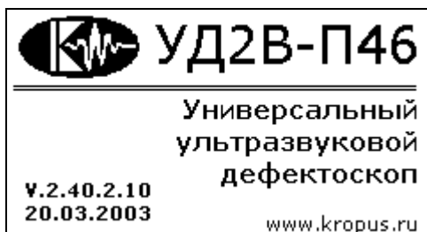
Рис. 4. Вид экрана дефектоскопа после включения.
