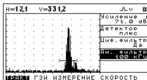
Рис.2-5 Преобразователь 100кГц, теневой сигнал по воздуху. а) без применения фильтров б) с аналоговым фильтром 100кГц
