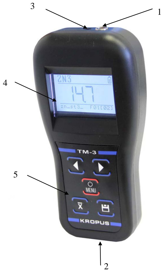
Рис. 2 Внешний вид толщиномера ТМ-3
