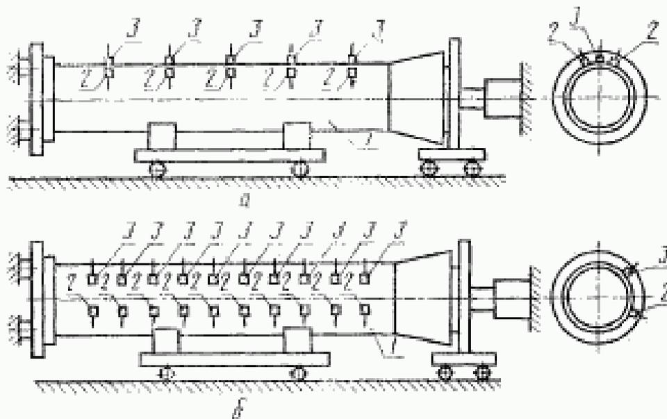
*г* — труба; *2* — излучатель; *3* — приемник
